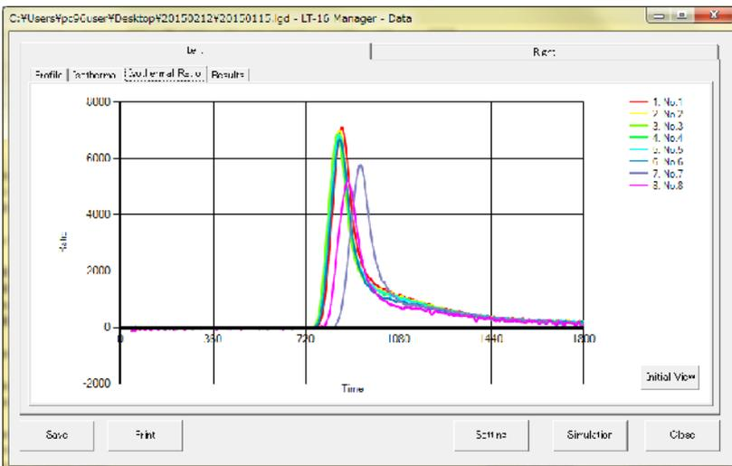
LT-16本体各ウェルの増幅曲線を微分解析することで、増幅開始時間及びDf値(差分曲線ピークの高さ)を確認できます。
