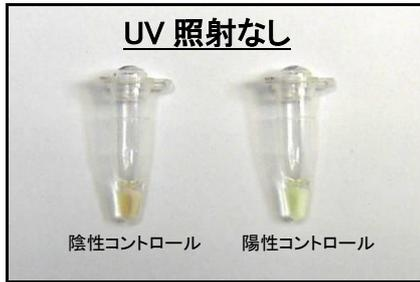
60分間保温した後、80°Cで2分間の熱処理により検査反応を停止し、判定を行います。
