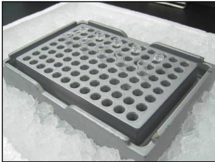
核酸の汚染がないピンセットを用いて検査用チューブを袋から取り出し、アルミブロックあるいはプレートラックに立て、検査溶液を 5.0  $\mu\text{l}$  ずつ分注します。
