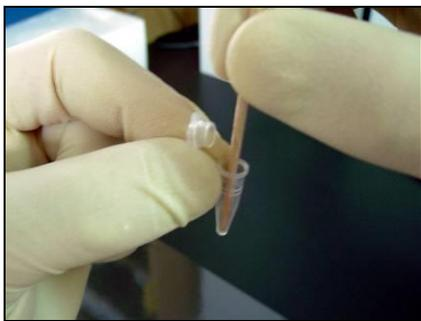
サンプルが付着した爪楊枝を検査溶液に浸して検査用チューブの底に軽くこすり付けます。その後、爪楊枝は速やかに取り出し、ビニール袋にまとめて廃棄します。サンプル添加後、各チューブにミネラルオイルを 10.0  $\mu\text{l}$  ずつ分注してキャップを閉じます。
